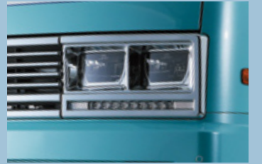
■LEDヘッドライト(角型4灯)・デイトタイム・ランニング・ランプ
