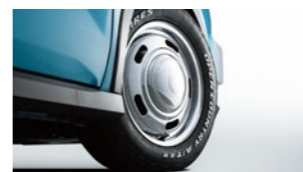
■ MOONクローム(16×6.0J+40) + オープンカントリーA/T EX (195/65R16) ※画像は最終仕様とは異なります。
